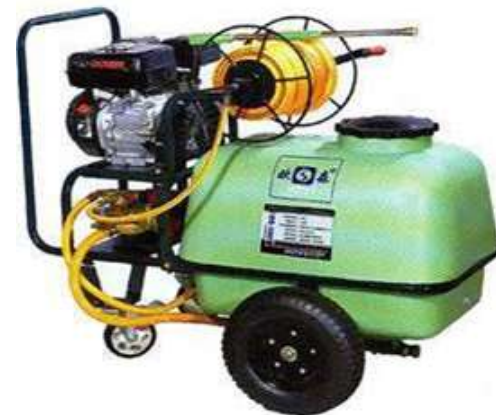
Τροχήλατος μικρός ψεκαστήρας γενικής χρήσεως
