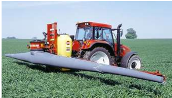
Ψεκαστικό μεγάλων καλλιεργειών με υποβοήθηση αέρα
