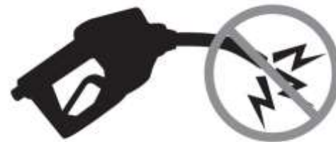
Η εκκένωση στατικού ηλεκτρισμού όταν υπάρχουν εύφλεκτοι ατμοί μπορεί να προκαλέσει πυρκαγιά ή έκρηξη
